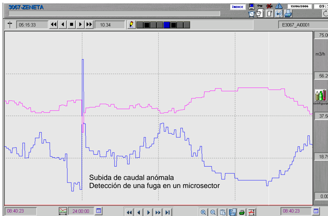
Figura 3. Detección de fuga en un microsector
